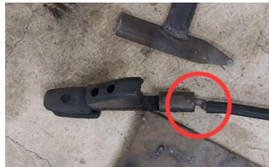
Figura 6. Fissura no cabo (Fonte: Autoria própria).
