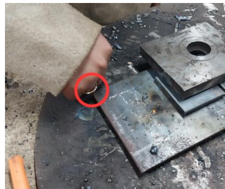
Figura 9. Soldador fazendo parte do circuito (Fonte: Autoria própria).
