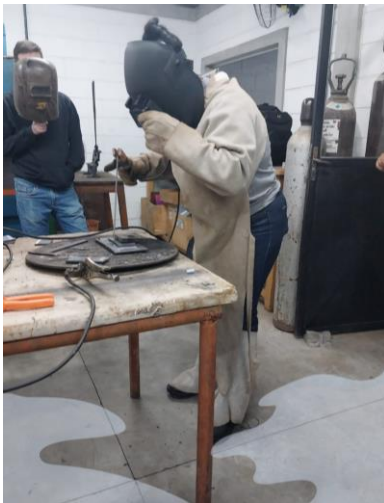
Figura 1. Piso molhado - Risco à segurança do soldador (Fonte: Autoria própria).
